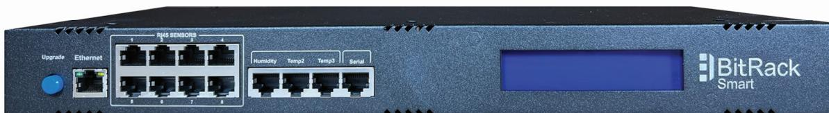
سیستم کنترل و مانیتورینگ اسمارت بیت رک، راه حلی یکپارچه و پیشرفته برای گزارش گیری و پایش پارامترهای مختلف رک و همچنین شرایط محیطی فضاها (با کنترل حداکثر دو رک) مانند: دما و رطوبت، نشتی آب، سیستم دزدگیر، اعلام حریق و ... می باشد.
